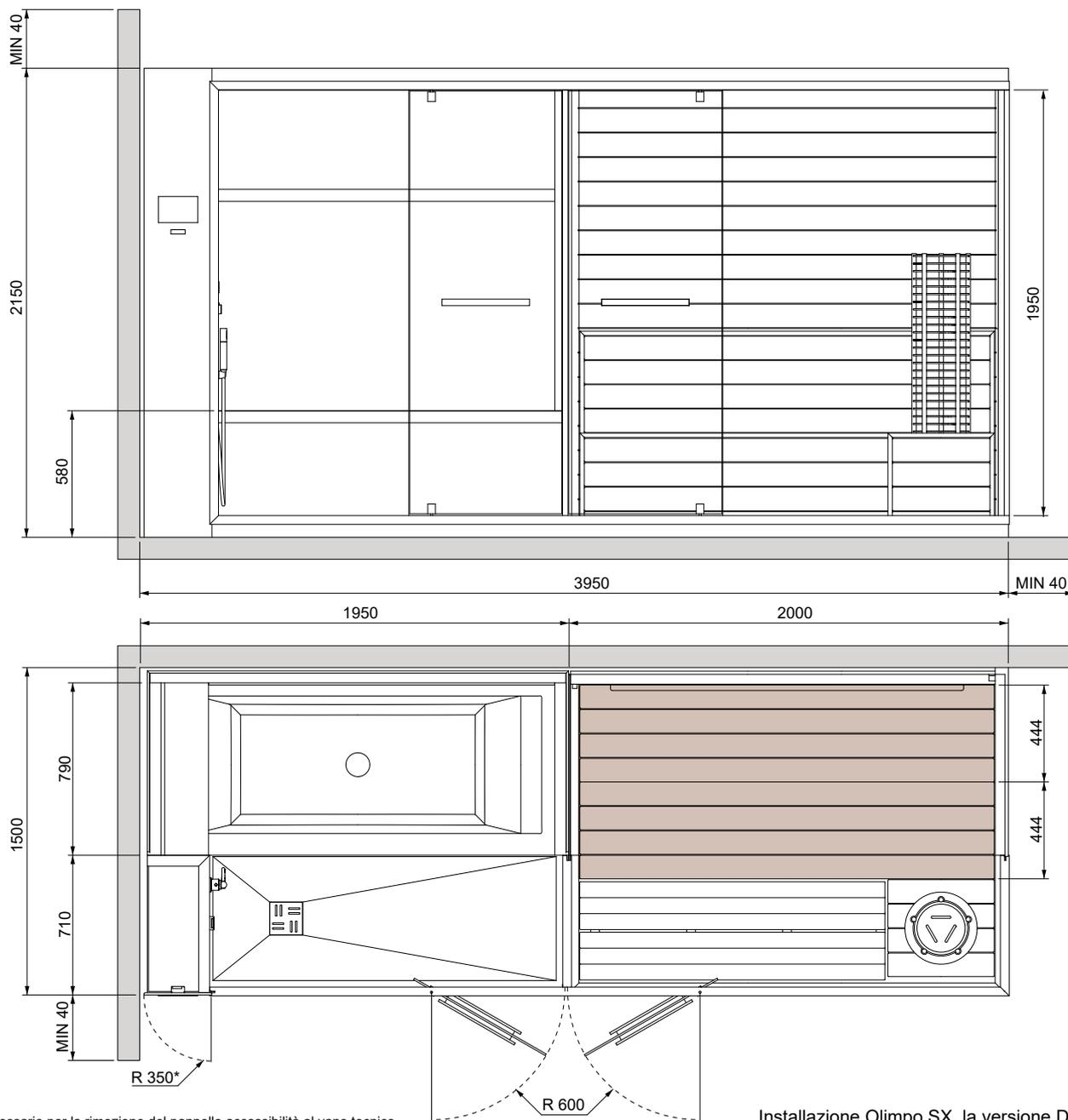
\*Spazio necessario per la rimozione del pannello accessibilità al vano tecnico.
